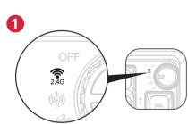
1. 旋钮开关拨到2.4G位置。 2. FN+P长按对码,P键闪烁插入接收器,P键停止闪烁即对码成功。
